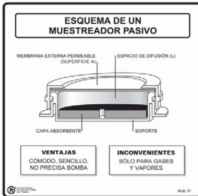
atravesando los orificios por difusión molecular, fijándose en el lecho sobre la base de la concentración ambiental y el tiempo de muestreo.
